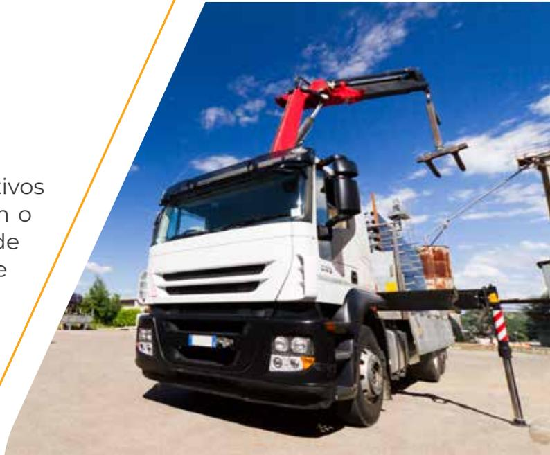
O inclinômetro VBC-012 G é um inclinômetro projetado para caminhões do tipo “munck”. Monitora o ângulo de nivelamento do caminhão e impede o funcionamento da lança caso haja alguma condição insegura de operação
